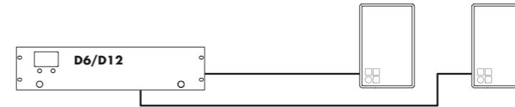
D6/D12 amplifier in Dual Channel mode for E4, E5, E6, E8, E12 or E12-D
